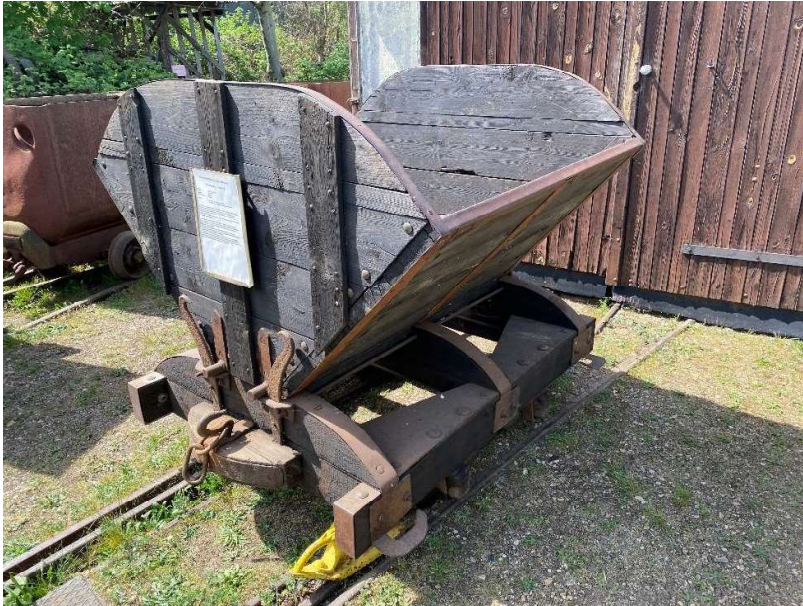
Bild 18: Dies waren die typischen Loren, mit denen der Kies lange Zeit transportiert wurde – dieses Exemplar ist eine Rekonstruktion einer Lore von 1885. (Foto: Stiftung SSB)
